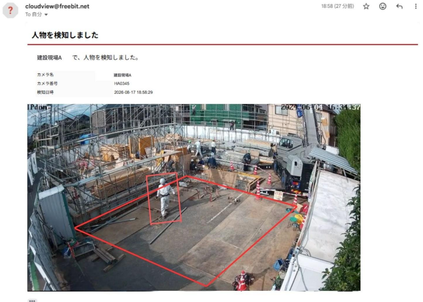
FIG 33 通知メールの例（人物検知）。差出人は cloudview@freebit.net。検知エリアと検知した人物が赤枠で表示されます。
