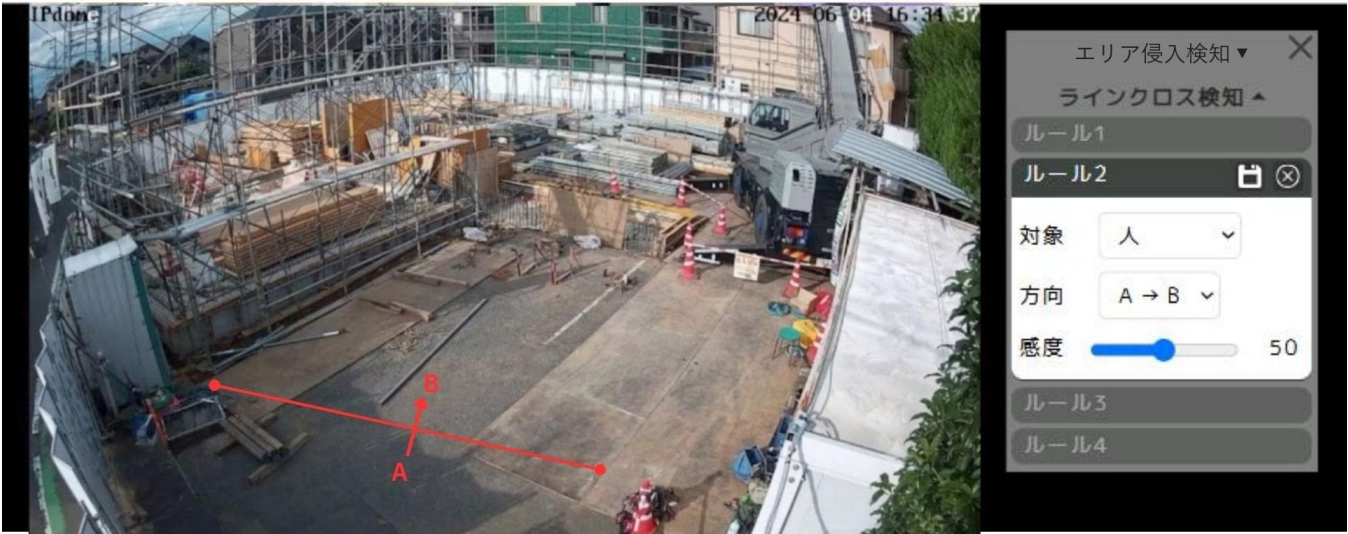
FIG 29 ルール 2 を開いたところ。線の両端が A と B、矢印が検知する向きを示します。
