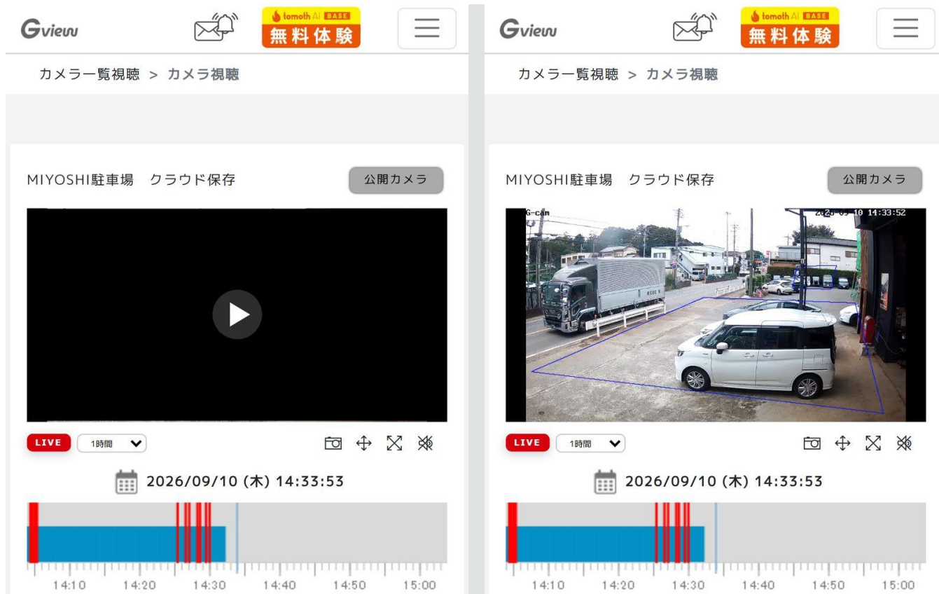
FIG 37 左：▶が表示された状態。タップすると右のようにライブ映像が始まります。
